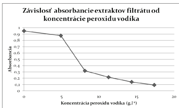
Obr. 3. Závislosť absorbancie extraktov filtrátu od koncentrácie H_2O_2
