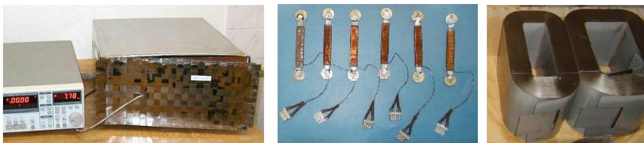
Obr. 1. Príklady aplikácií kovových skiel: magnetické tienenie elektronického zariadenia (vľavo), snímače tlakových a ťahových napätí (v strede) a jadrá transformátorov (vpravo)
